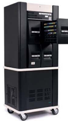
BACT/ALERT 3D Low Temperature (LT) Module • 20-25°C
